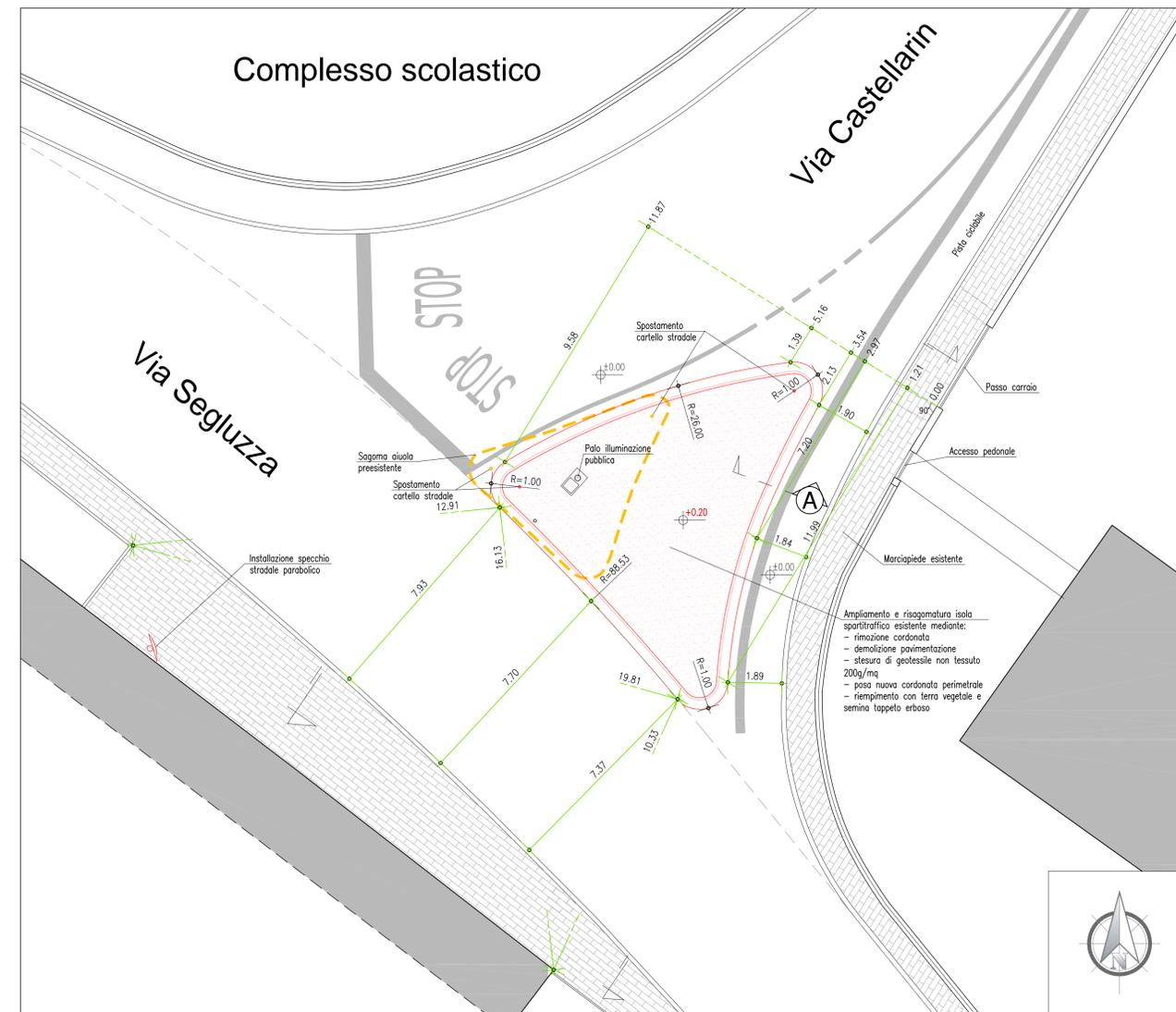
Dettaglio isola spartitraffico incrocio con Via Segluza, Scala 1:100
